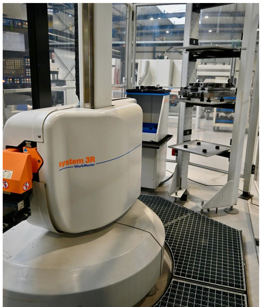
De robot transporteert twee soorten pallets in en uit de freesmachine
