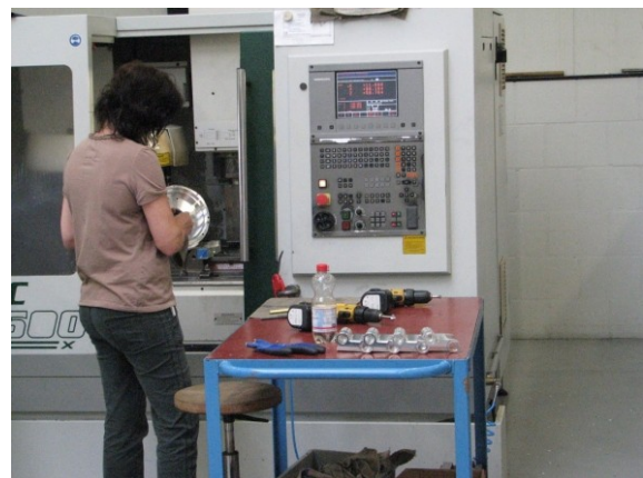
Vrijstaand Bridgeport VMC 600 bewerkingscentrum in actie
