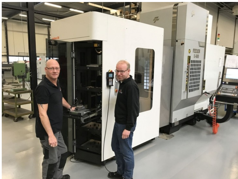
Nieuwste Freeler U600 VBC met Heidenhain sturing en frontaal optimale toegang voor de operator
