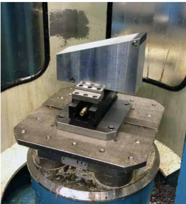
MZU 360-125 mit Grip-Wendebacken MZU 360-125 with reversible grip jaws
