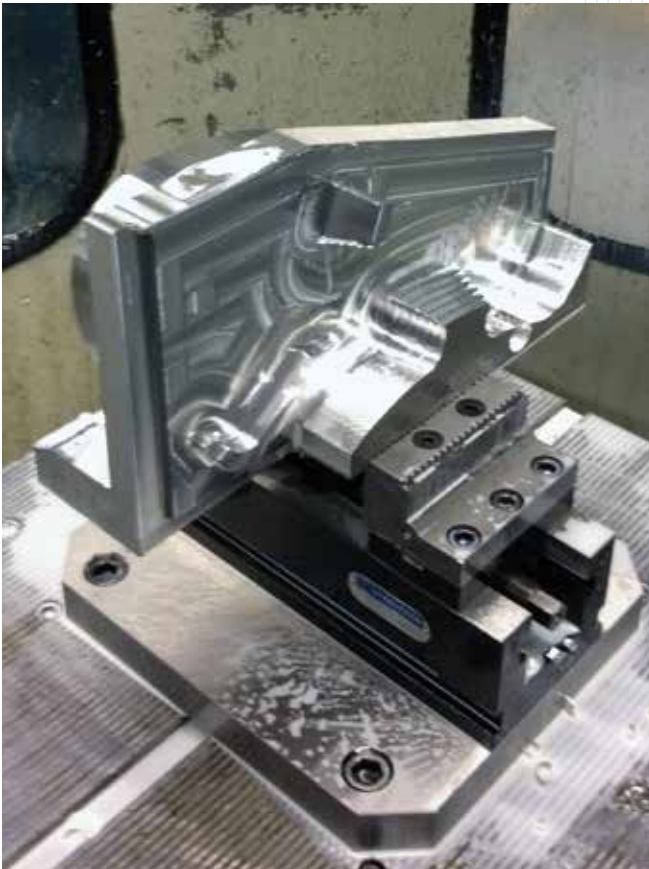
MZU 360-125 mit Stufen-Wendebacken mit Gripeleisten MZU 360-125 with reversible stepped jaws with grip inserts
