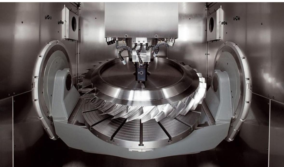
Blisks, ofwel turbine wielen, vereisen door hun vloeiende, verlopende vrije vorm een vijfassige, simultane bewerking
