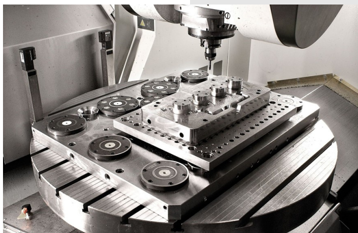
Machinetafel bezet met nulpuntspanelementen
