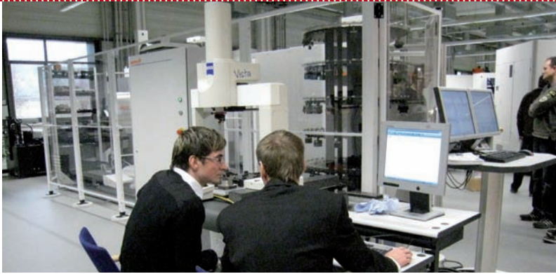
De portaalmeetmachine Zeiss Vista CNC, voor het nullen van elektrodes en werkstukken. De machine meet met een Renishaw PH6-kop met een TP200-taster. Links de schermen van de 'CellManager'
