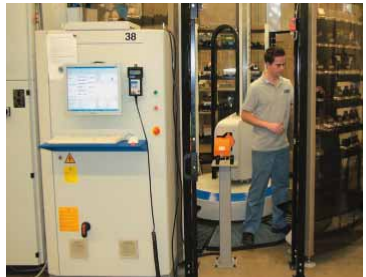
Een palletmagazijn in combinatie met een robot zorgt voor een toename van de machine-uren
