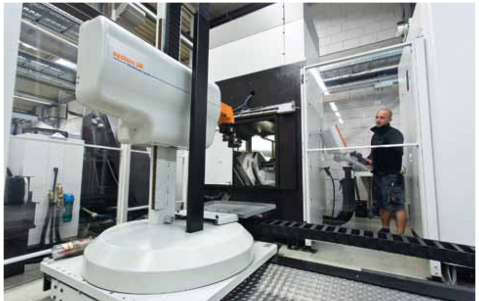
Kwaliteit vereist een integrale benadering, zo laat Otto Klumpp zien bij de werkwijze in de productiecel, bestaande uit een Mikron HSM 600 ULP freesmachine, een Form 3000 HP zinkvonkmachine, een Zeiss Dura Max meetmachine en een 3R Work Master Linear robot.
